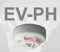
Rivelatore di fiamma ultravioletto analogico indirizzato EVOLUTION, rileva la luce ultravioletta emessa dalle fiamme, indirizzamento da dipswitch, led di segnalazione allarme, uscita per led di segnalazione remota. Fornito senza base, base compatibile mod. STB-4-EV. Assorbimento 1mA (a riposo), 5,2mA (in allarme), alimentazione 35Vcc dal loop. Marcatura CE.
